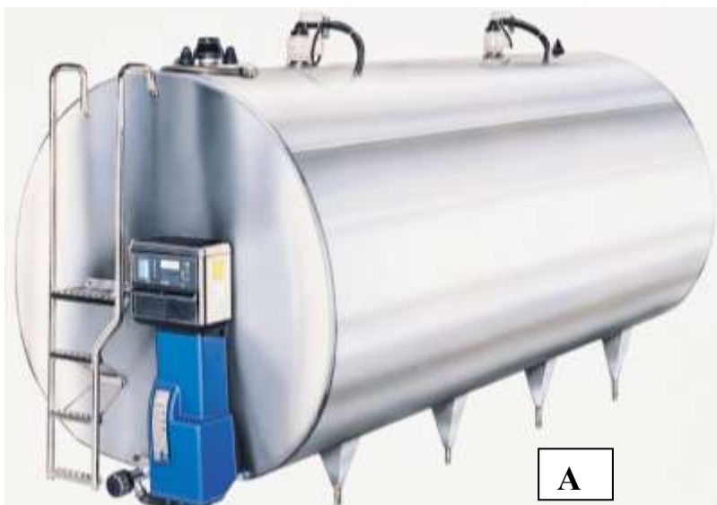
Фигура 10. Атмосферно-затворени хладилни резервоари (танкове) с различна форма и обем за охлаждане и съхранение на суровото мляко във фермата: А - хоризонтален; Б - вертикален
